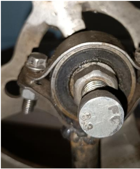
Рисунок 2.21-2.22 Изготовление ручки и закрепление звезды на стержне
