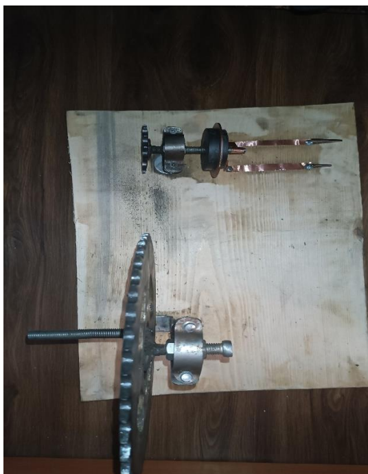
Рисунок 2.30 Монтаж звезд и щеток.
