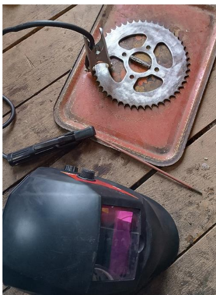
Рисунок 2.18 Привариваем стержень к звезде.
