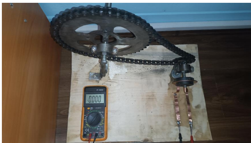
Рисунок 2.31 Генератор Фарадея в сборе.
