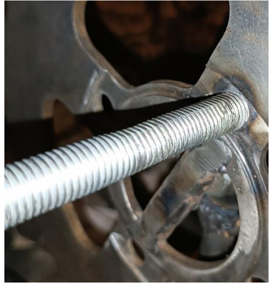
Рисунок 2.21-2.22 Изготовление ручки и закрепление звезды на стержне
