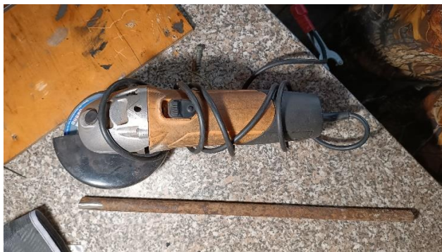
Рисунок 2.17 Отрезаем кусок 58 мм.
